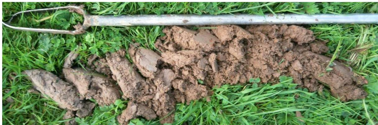
*Sondage S43 montrant un sol limoneux moyennement profond, avec des traces d'hydromorphie s'intensifiant en profondeur*
