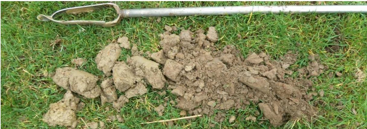
*Limon marron grisâtre, devenant bariolé en profondeur, avec présence d'eau qui est remontée à 50 cm : sol hydromorphe caractérisant une zone humide (sondage n°4)*
