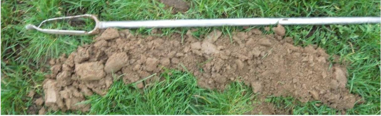
*Limon marron pas très homogène du fait des passages caillouteux, avec un passage un peu grisâtre entre 50 et 85 cm, mais redevant sain à partir de 85 cm de profondeur : sol ne caractérisant pas une zone humide (sondage n°1)*
